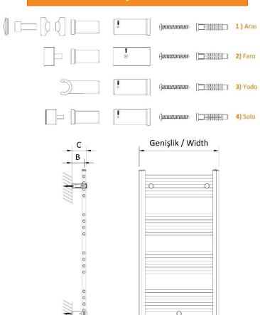
Model Aks / Centres (mm) B (mm) C (mm) Min 75-Max 100 Min 87-Max 112 Width - 25 Aras Width - 30 Min 90-Max 110 Min 108-Max 128 Faro Min 90-Max 110 Min 108-Max 128 Yodo Width - 30 Width - 50 Min 85-Max 110 Min 115-Max 140 Solo
